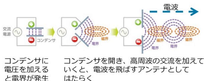
次に、電波が発生する原理を簡単に説明します。先ほどの例の電波塔の中で、どういったことが起こっているかということ、まず、2枚の金属の板を並行に並べたコンデンサを用意します。ここに電源をつないで、電圧を掛ける。乾電池のような直流の電源をつないだと考えてください。このとき、金属板の片方がプラス、もう片方がマイナスという電気を帯びます。そうしますと金属板の間に電界が発生します。電界というのは、電気にとっての重力みたいなもの、重力がプラスからマイナスの方に働いているとお考えください。この中に電気を帯びた粒をポンと置きますと、電界に引っ張られてその粒が動く。そんなものが発生する。
