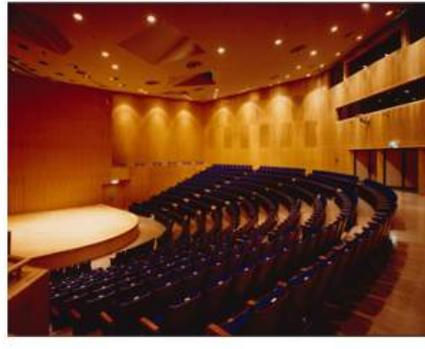
おります。壁と天井がコンクリートなので、合板のように振動による反射音の吸収がなく、低音域の残響時間がすごく伸びまして、見た目もそうですが、ドライで音が硬いという人もおりますけれども、逆に音がクリアになる。個々の楽器の音が混ざり合うことなく、明瞭な輪郭があってとてもクリアに聞こえる。実はこれは、残響が多いと上手くなった気がしちゃって上達しないという学校の希望がありまして、残響
